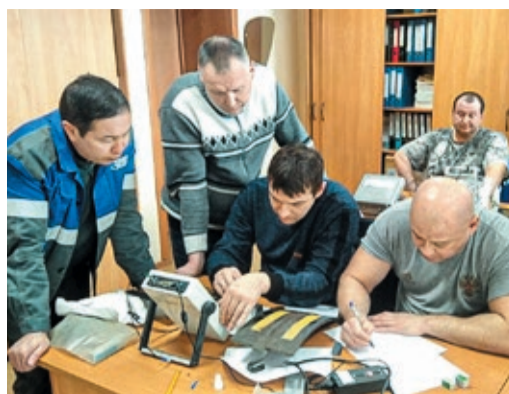
Качество дефектных стыков дефектоскописты определяли на образцах трубы «пяτισотки»
