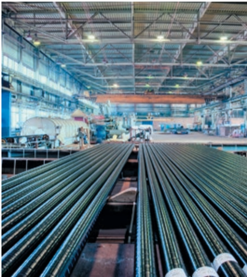
Восстановленные трубы можно вновь использовать на трассе
