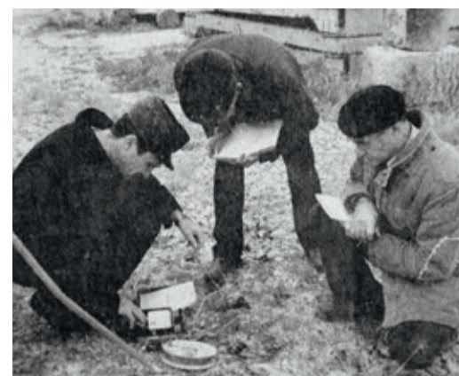
Измерение блуждающих токов на конкурсе монтеров ЭХЗ (2005 г.)
